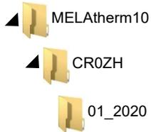
Das Gerät prüft bei jeder Art der Protokollausgabe (Sofortausgabe nach gelaufenem Zyklus oder Übertragung mehrerer Protokolle auf einmal) das Speichermedium und legt automatisch bei Nichtvorhandensein ein Verzeichnis des Gerätes und des Monats an. Werden Protokolle mehrfach auf ein- und dasselbe Speichermedium ausgegeben, wird dort unter dem Geräteverzeichnis ein Verzeichnis mit dem Namen „Doppelt“ angelegt, in dem diese Protokolle nur einmal abgelegt werden.
