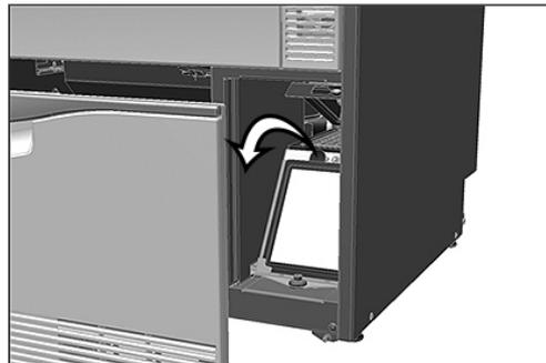
5. Schließen Sie die Abdeckklappe und drehen Sie die Schraube handfest zu.
